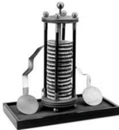
Arriba: Detector de descargas atmosféricas de Galvani. Abajo: Pila de Volta
